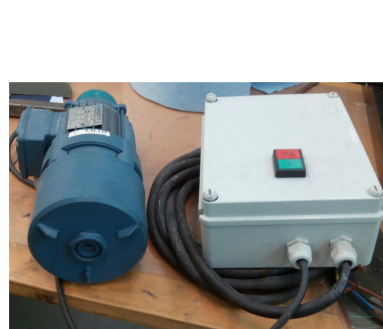
Fig. 2. Motor de corriente continua al rodillo de entrada
