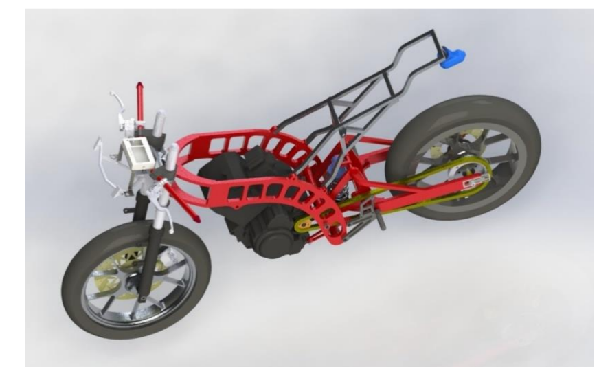
Fig. 13. Ensamblaje final con la moto y situación del tablier y el soporte para la cámara.
