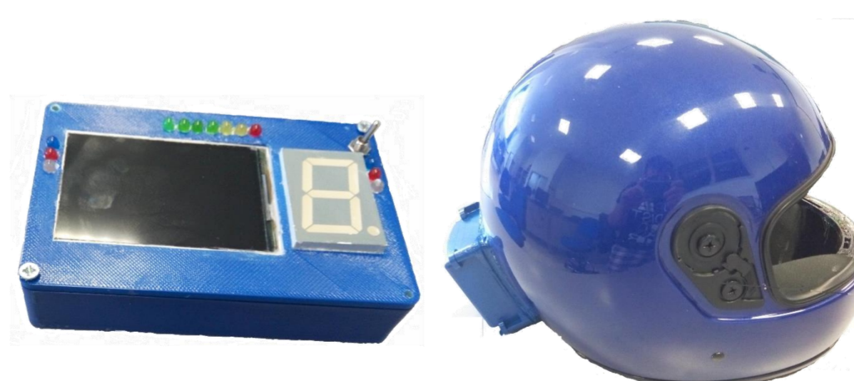
Fig. 12. Montaje final del tablier y del casco inalámbrico
